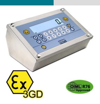
Wäge-Indikator mit Edelstahl-Gehäuse IP68, geeignet für explosionsgefährdete Bereiche, ATEX-Kennzeichnung: ATEX II 3G Ex nR IIC T6 Gc X für Gase ATEX II 3D Ex tc IIIC T130°C Dc IP68 X für Staubpartikel. Geeignet für Zonen 2 und 22, einsetzbar als Wäge-System, zur Dosierung und Automatisierung. CE-M eichfähig (OIML R-76 / EN 45501).
