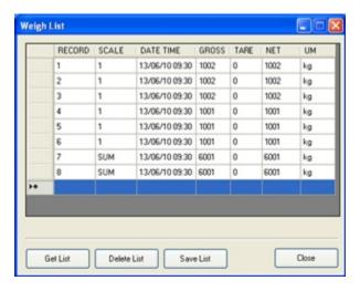
Ablesen der Wägelisten mittels der Software "Weigh Console", mit der Möglichkeit diese in Excel oder \*.csv – Format zu speichern. Für weitere Informationen ziehen Sie das <u>Datenblatt</u> zu Rate.
