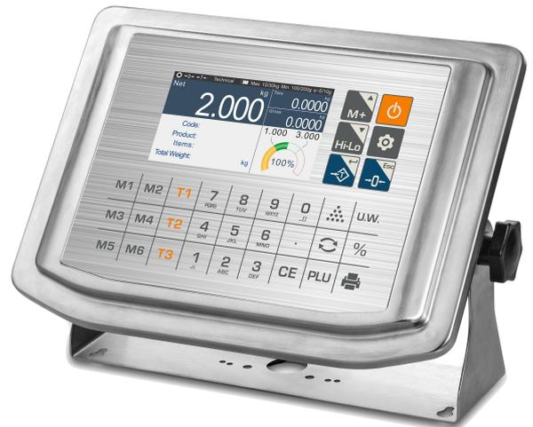
Multifunktionale Wägeterminals mit Gehäuse aus ABS Kunststoff oder Edelstahl, numerischer und funktionaler Tastatur mit 34 Tasten, und einem 4.3" farbigem Display (480x272), zur Anzeige des Gewichts und zusätzlicher Informationen. CE-M eichfähig (OIML R-76 / EN 45501).
