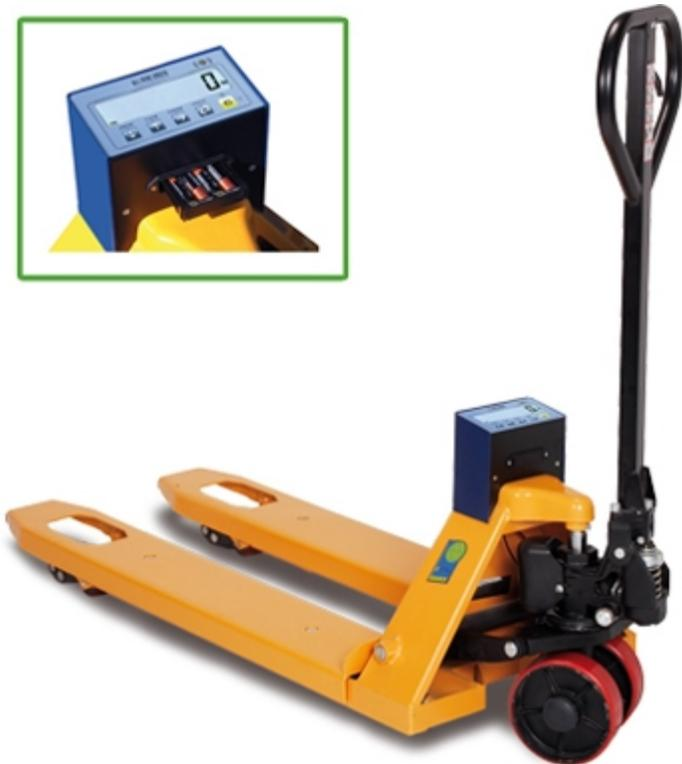
Gabelhubwagen mit Waagenfunktion TPWN09, einfach in Gebrauch und Handhabung. Ausgestattet mit 4 Wägezellen (Scherkraft), die eine höhere Präzision bei den Wägevorgängen erlauben und einer multifunktionalen Gewichtsanzeige. Großes hintergrundbeleuchtetes Display, das eine optimale Ablesung des Gewichts auch bei schlechten Lichtverhältnissen erlaubt. Auch als Version mit integrierter Fernbedienung lieferbar.
