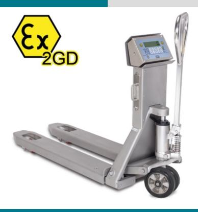
Gabelhubwagen mit Waagenfunktion, geeignet für den Einsatz in explosionsgefährdenten Bereichen (ZONEN 1 und 21 & 2 und 22), Atex-Kennzeichnung Ex II 2GD IIB T4 T197°C X. Die Lastaufnahme über 4 Atex-zertifizierte Wägezellen (Edelstahl, IP68) garantiert optimale Wägeergebnisse in allen Betriebsarten. Hubwagen ist komplett in Edelstahl. Verfügbar auch in eichfähiger Version (CE-M).
