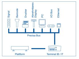
**Terminal IB / IT**Anschlussmöglichkeit für:
